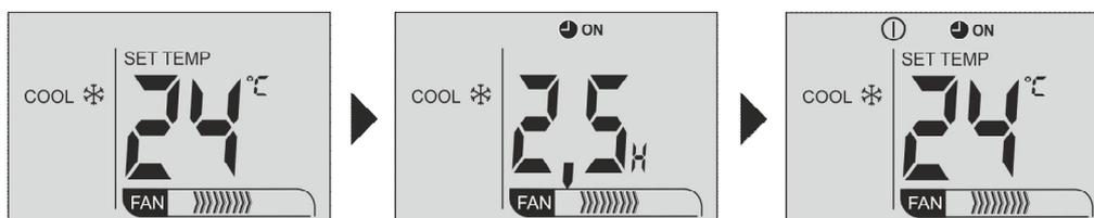
Beispiel: Das Klimagerät schaltet nach Ablauf von 2 Stunden 30 Minuten den Kühlbetrieb ein, mit einer Solltemperatur von 24°C und der Ventilatorstufenzahl „Hoch“.
